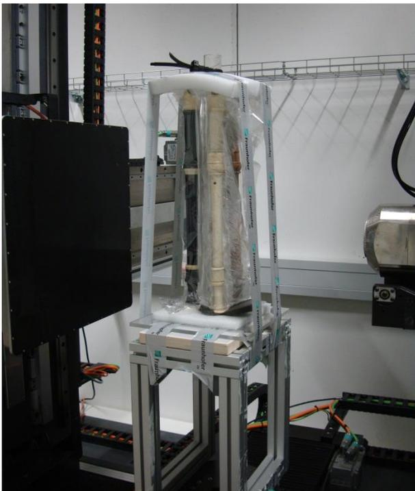
*Vier Blockflöten des 18. Jahrhunderts in variabler Halterung und Klimaschutzverpackung; links der Röntgendetektor, rechts die Röntgenquelle*
