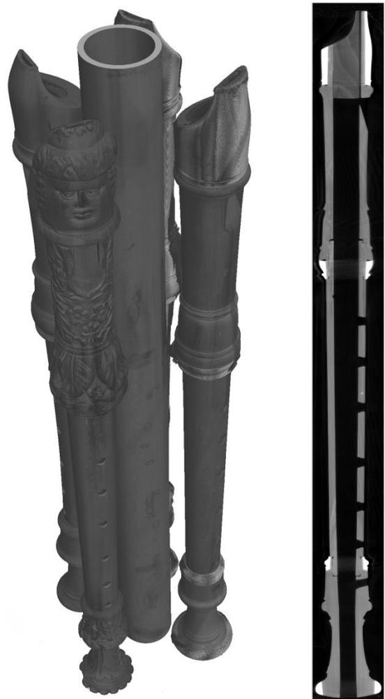
*3D-CT-Ansicht des Blockflötenclusters und Querschnitt eines Einzelinstruments*
